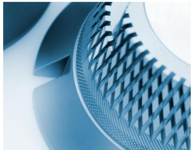
Das Prinzip der PUC-Kolloidmühle basiert auf einem Rotor/Stator System. In einem auf das zu verarbeitende Produkt abgestimmten und entsprechend verzahnten Stator dreht ein ebenfalls speziell verzahnter Rotor. Durch die voneinander abweichende Konizität der verzahnten Kegelflächen entsteht ein in Flußrichtung zum Austrittsquerschnitt hin enger werdender Ringspalt.
