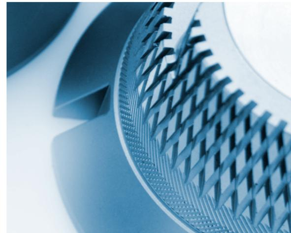
Das Prinzip der PUC-Kolloidmühle basiert auf einem Rotor/Stator System. In einem auf das zu verarbeitende Produkt abgestimmten und entsprechend verzahnten Stator dreht ein ebenfalls speziell verzahnter Rotor. Durch die voneinander abweichende Konizität der verzahnten Kegelflächen entsteht ein in Flußrichtung zum Austrittsquerschnitt hin enger werdender Ringspalt.
