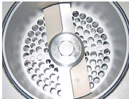
Ausgangsprodukt und der gewünschte Zerkleinerungsgrad bestimmen den Durchmesser der Bohrungen der Lochscheibe. Daher sind Lochscheiben mit verschiedenen Bohrungsdurchmessern lieferbar.
