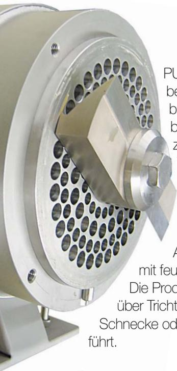
PUC Lochscheibenmühlen werden beispielsweise bevorzugt eingesetzt zur Vorvermahlung, Verpulpung und Vermahlung von Früchten und Gemüse unterschiedlicher Arten und Sorten mit feuchter Konsistenz. Die Produkte werden über Trichter oder inline über Schnecke oder Pumpe zugeführt.
